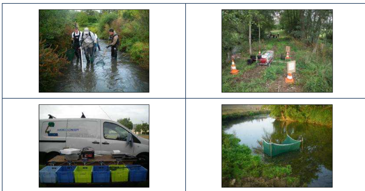
Figure 27 : Photos du matériel utilisé pour la pêche électrique (de gauche à droite et de haut en bas) : action de pêche, groupe électrogène, balance, poubelles et caisses de stockage, filet de stockage
