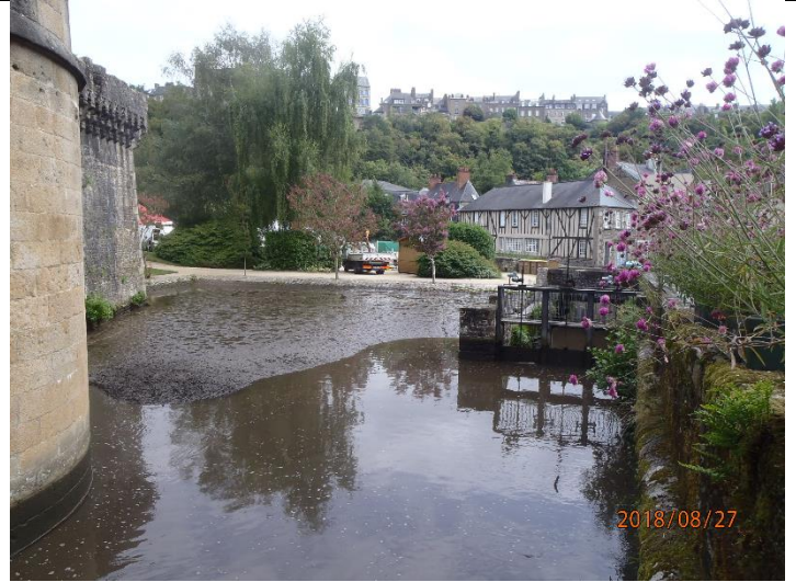
Test d'abaissement du 27/08/2018 – emprise du miroir d'eau
