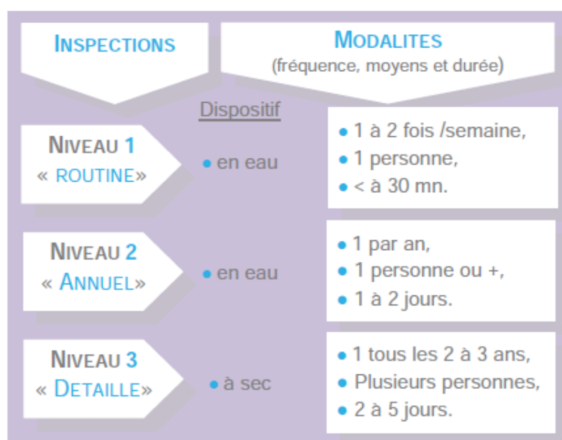
Figure 32 : Synthèse des niveaux et modalités d'inspections associées (guide passe à poisson VNF)
