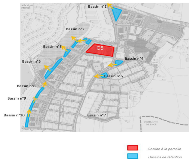
Figure 1 : Carte de synthèse réseaux eaux pluviales - La Vigne (Source : ARCHIPOLE, LA PLAGÉ)
