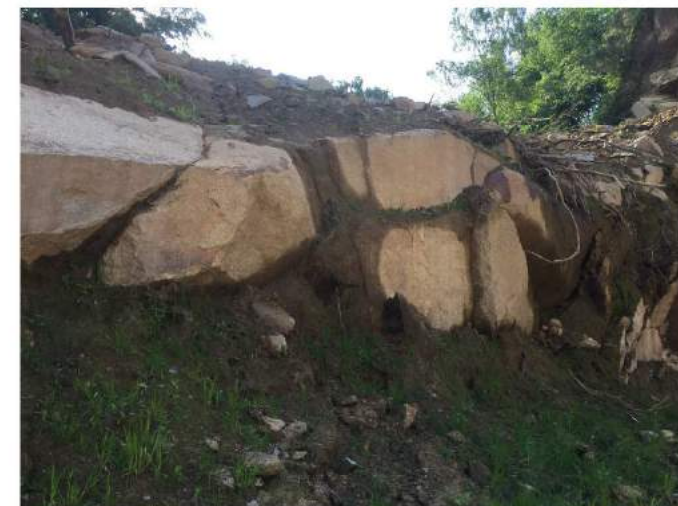
7716 - l'intersection des diaclases et des joints horizontaux délimitent un début d'altération en boules
