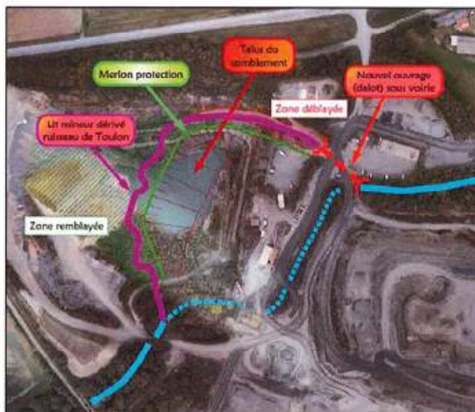
**Figure 5.** Schéma de principe de la dérivation du ruisseau du Toulon (source : Vatna Conseil)
