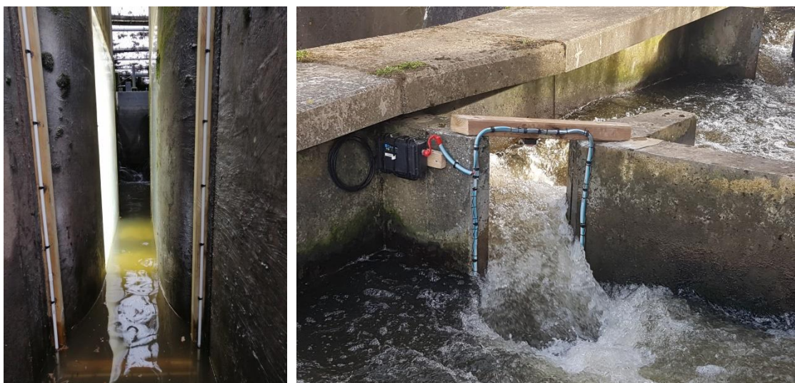
Exemple d'antennes de réception RFID installées par FISH PASS
