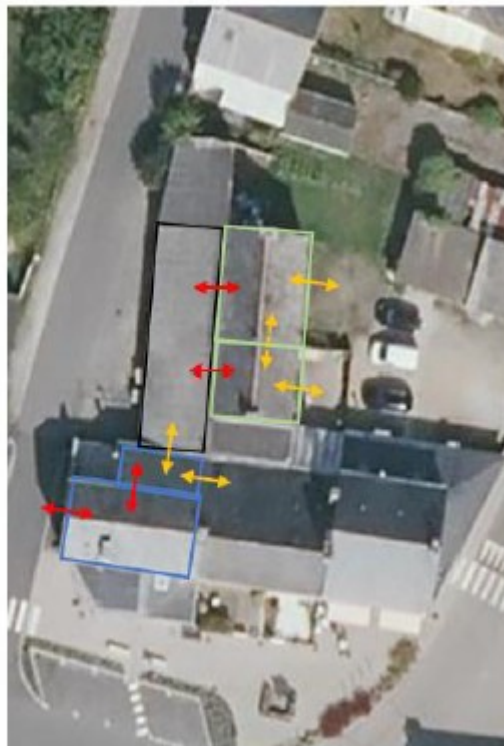
Schéma général des bâtiments, des ouvertures existantes et celles à créer afin d'assurer une passerelle entre les différents combles (Source : Géoportail & CERESA)
