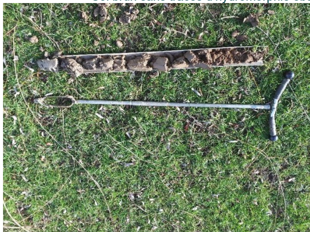
Sol brun sans traces d'hydromorphie observé avant 50 cm de profondeur → non humide
