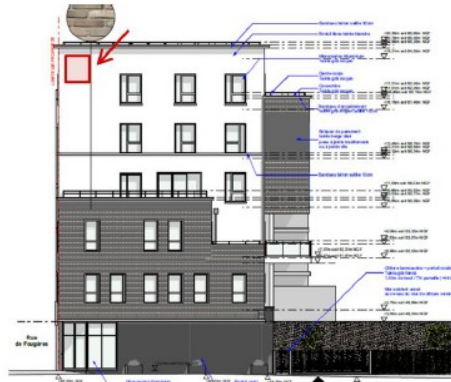
Localisation du gîte à chiroptères sur la façade X du projet de Pierre Promotion © Liouville Jan & Associés Architectes
