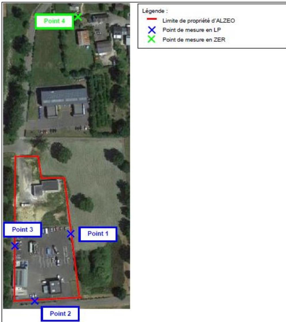
**FIGURE 18 : IMPLANTATION DES POINTS DE MESURE DE BRUIT – ETAT INITIAL**
