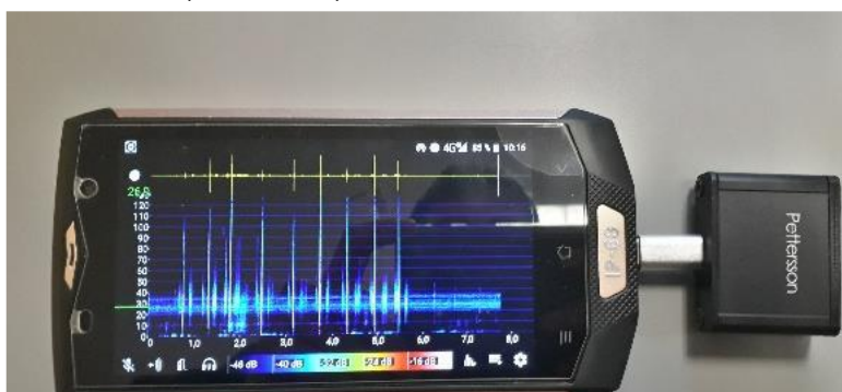
Figure 90: Micro Pettersson u256 USB Ultrasound Microphone relié à l'application BatRecorder
