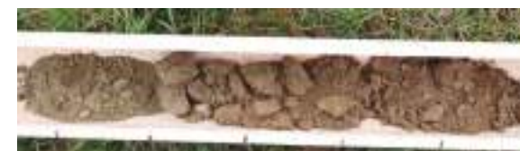
Morphologie des sols correspondant à des "zones humides" (LFI): - Horizon réducteur peu marqué (g) - Horizon réducteur marqué (g) - Horizon oxic - Horizon limoné - Horizon argilo-ferrique
