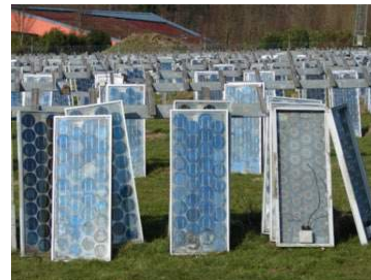
Figure 75 : Panneaux photovoltaïques en fin de vie (source : Soren, 2015)
