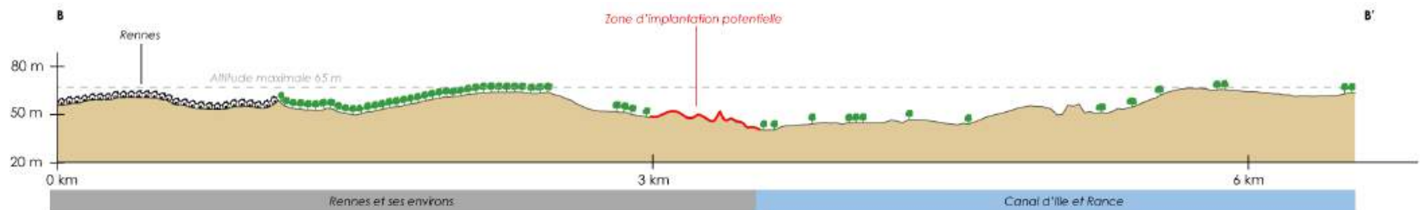
Figure 2 : Coupe topographique BB' du sud-ouest au nord-est, à l'échelle de l'aire d'étude éloignée (exagération verticale x13)
