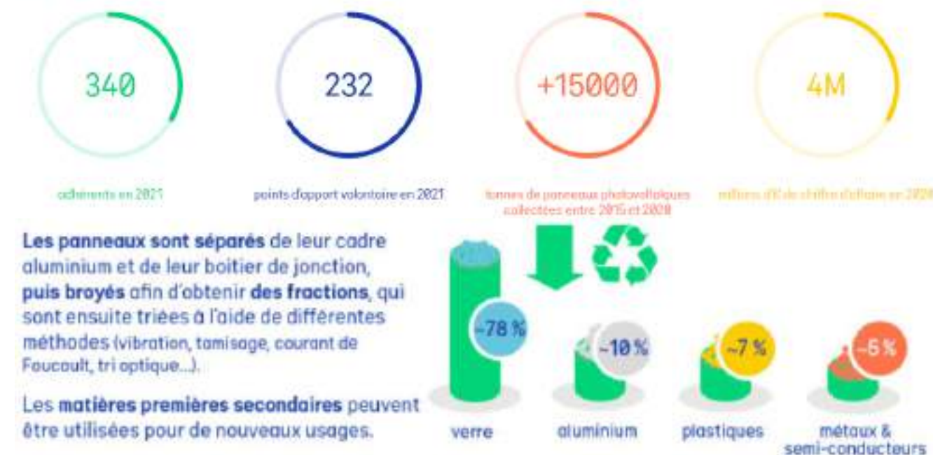
Figure 76 : Le traitement des panneaux photovoltaïques (source : Soren, 2022)
