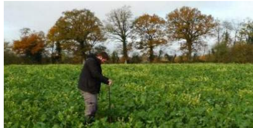
Figure 16 : Prélèvement à l'aide d'une tarière pédologique – photographie prise hors ZIP (source : Calidris, 2022)
