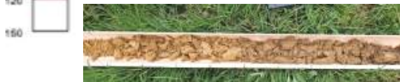
Morphologie des sols correspondant à des "zones humides" (LFI): - Horizon réducteur peu marqué (g) - Horizon réducteur marqué (g) - Horizon oxic - Horizon limoné - Horizon argilo-ferrique
