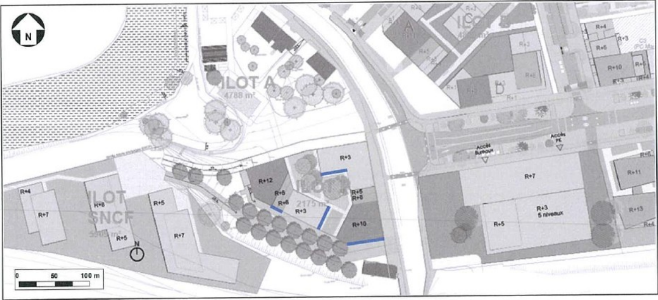
Plan masse du projet d'aménagement avec en bleu, l'implantation des gîtes à chiroptères (source : Territoires Publics – Egis 2023)
