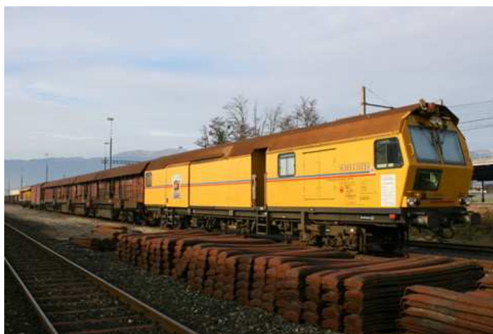
Train meuleur de rails (Scheuchzer S.A.)
