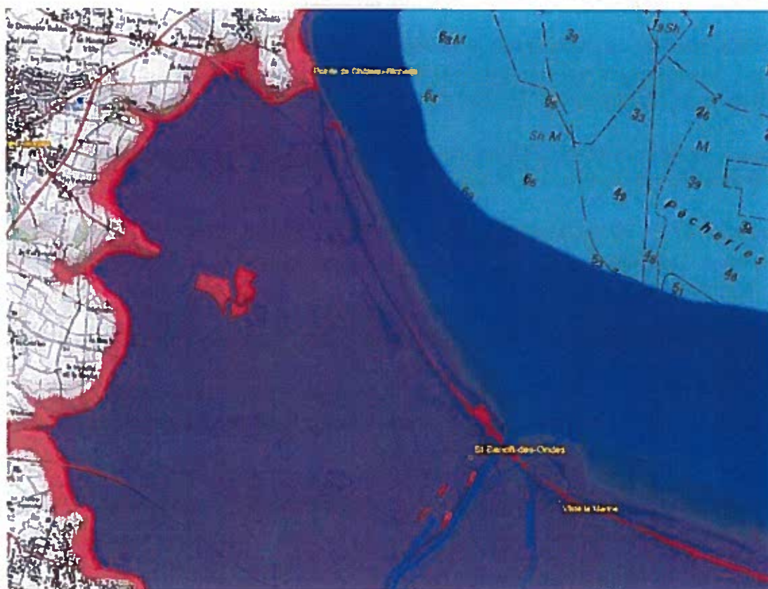
Figure 42 : visualisation de la partie de digue submergée pour un niveau marin de 8,80 m IGN69 entre la Pointe de Château-Richeux et St-Benoît-des-Ondes
